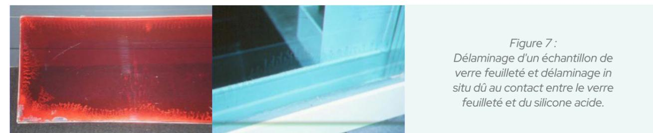
Figure 7 : Délaminage d'un échantillon de verre feuilleté et délaminage in situ dû au contact entre le verre feuilleté et du silicone acide.
