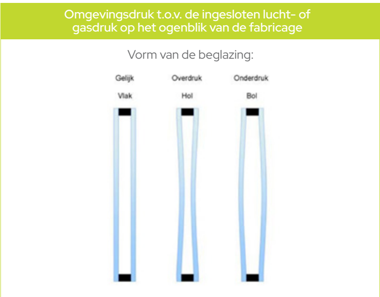
Figuur 20: Vervormingen van een isolerende beglazing te wijten aan drukschommelingen.
