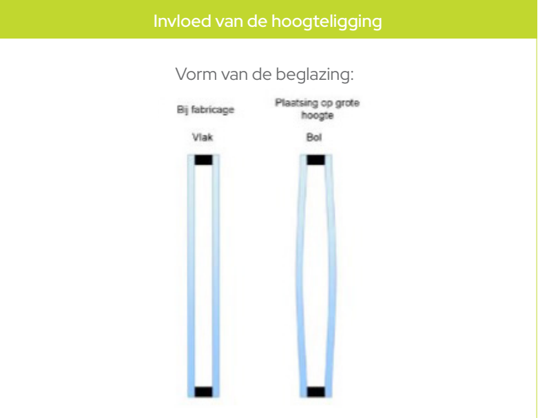
Figuur 21: Vervormingen van een isolerende beglazing te wijten aan hoogteschommelingen
